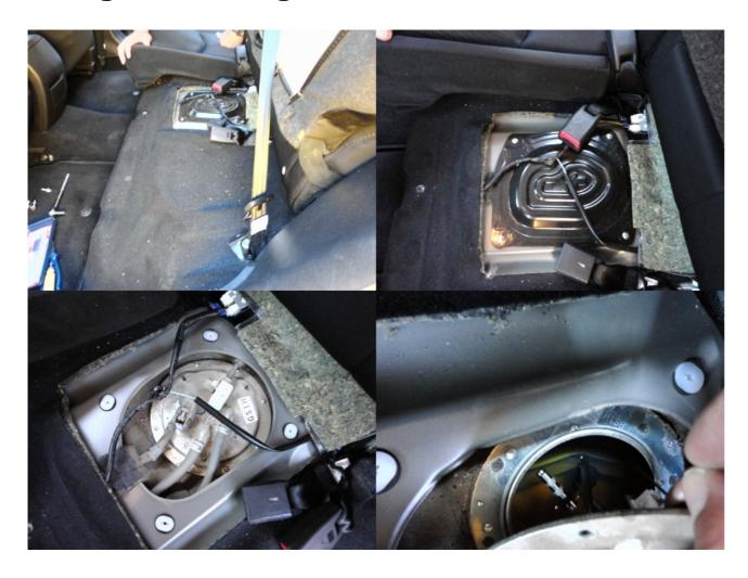
Die Montage des BE-Fuelsaver kann auch über den Tankgeber erfolgen, wir empfehlen diese wenn bei PKW's die Zufuhr über den Tankstutzen durch ein Tankschloß, Sieb oder eine verschlungene Zuleitung verhindert wird. Der Tankgeber befindet sich allgemein unter der Rücksitzbank und ist leicht zugänglich, Fachwerkstätten oder Fachpersonal können den Einbau innerhalb von 15 Minuten durchführen
